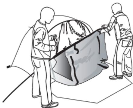
8. Al insertar las varillas en la manga, se recomienda hacerlo con una persona en cada extremo, para así facilitar su armado. **Nunca** tire de las varillas para pasarlas por las mangas ya que se desprenden y pueden dañar la tela. La mayoría de los daños en varillas se produce durante el montaje.
