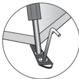
4. Estacar la carpa, poner las estacas a **45°** del suelo en dirección opuesta. Debe enterrar las estacas completamente, para que la carpa no se salga y evitar accidentes.
