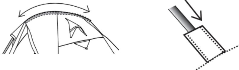
7. Enganche el cubretecho al cuerpo de la carpa con los broches y ajuste mediante las correas. Las puertas de la carpa se abren hacia los dos lados y se pueden arremangar para tener un mejor acceso, como se muestra en la figura. **Para incrementar la ventilación levante el faldón.**
